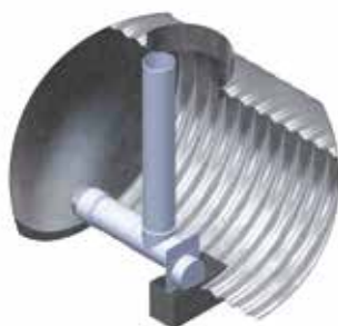
Trop plein intégré Version avec régulateur de débit extractible et marnage
