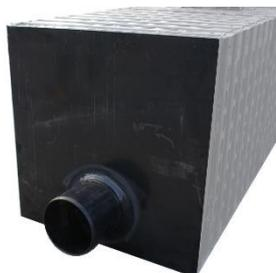
La plaque de raccordement peut être commandée dans n'importe quelle taille. Ce mode de raccordement est flexible, car la plaque peut être fixée à n'importe quel endroit et sur n'importe quel type de caisson, que ce soit sur le dessus du dispositif ou sur le côté d'un caisson. La plaque a une épaisseur minimale de 10 mm et l'embout soudé une longueur de 150 mm. Le diamètre de l'embout doit être déterminé à l'avance (personnalisation). Le tuyau / manchon à raccorder peut se glisser sur l'embout.
